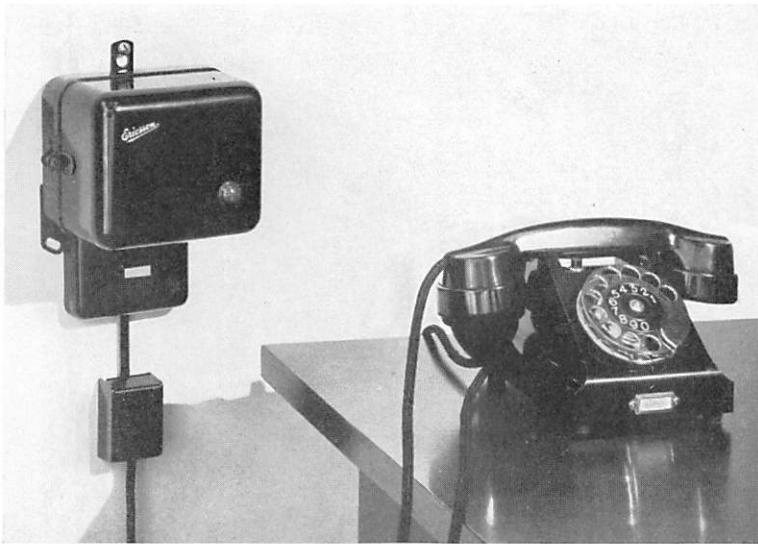
Apparaturutrustning för linjestation enligt L. M. Ericssons selektorsystem. Selektorskåp med telefonapparat.
