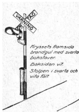
Ljussignal vid korsning mellan väg och ett järnvägsspår.
