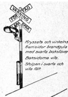
Ljussignal vid korsning mellan väg och flera järnvägsspår.
